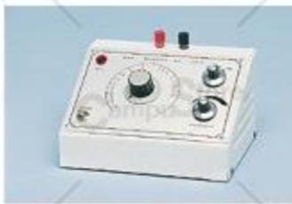
**Generatore di oscillazioni sinusoidali a frequenza acustica**
